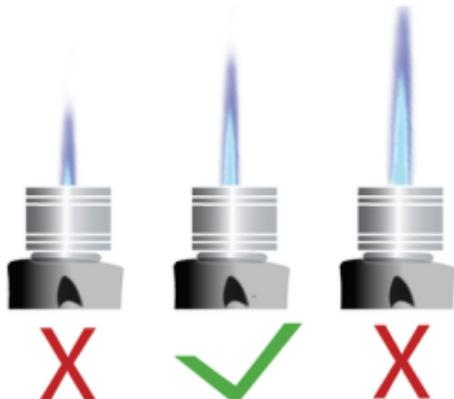
Petite flamme = chauffe plus longue, plus de contrôle. Flamme forte = chauffe plus rapide, moins de contrôle.
